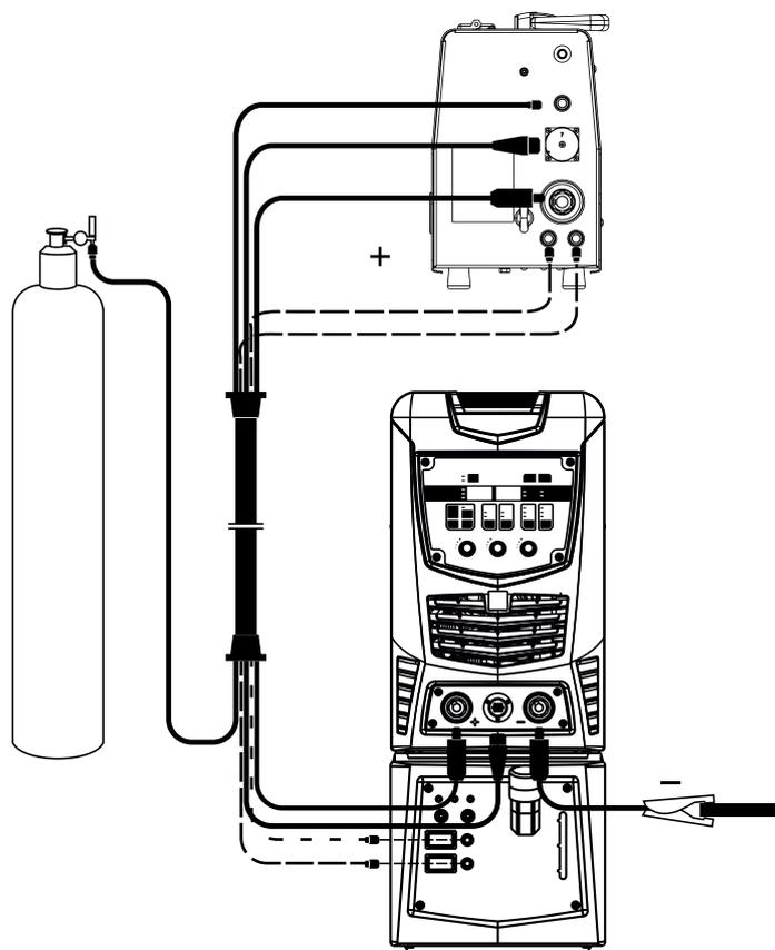
Рис. 4.3 Схема подключения механизма подачи сварочной проволоки
