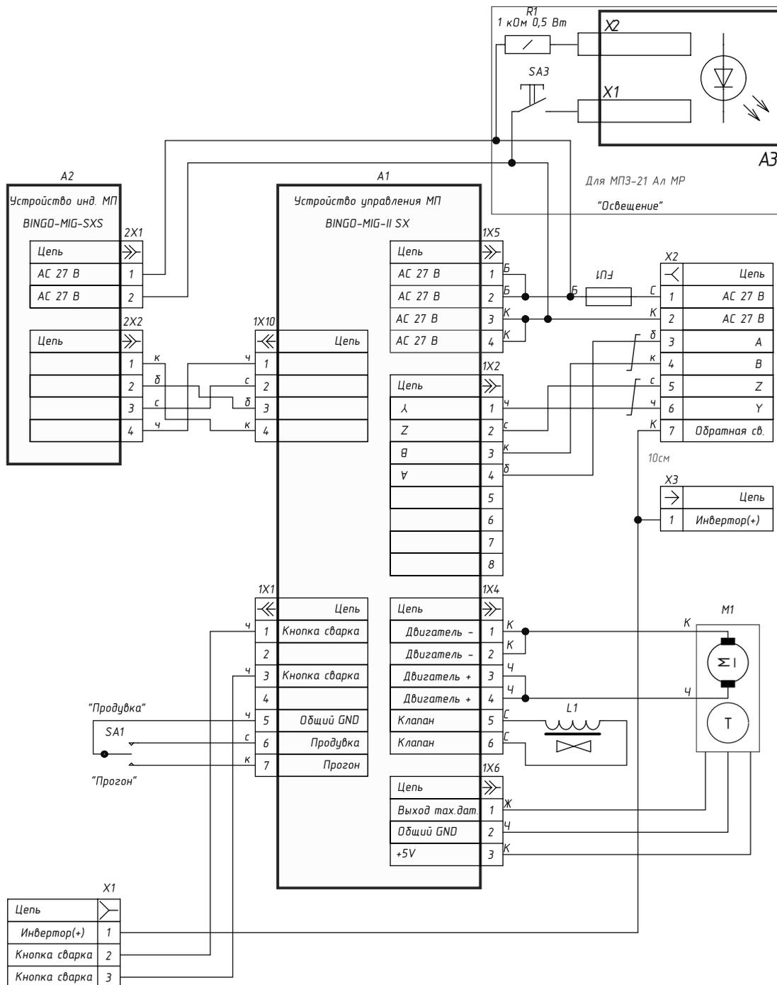
Рис. 3.3 Принципиальная электрическая блок-схема МПЗ-21 MX Pulse
